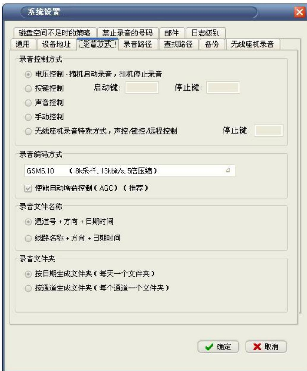
图 6.1 设置录音启动方式和编码方式
