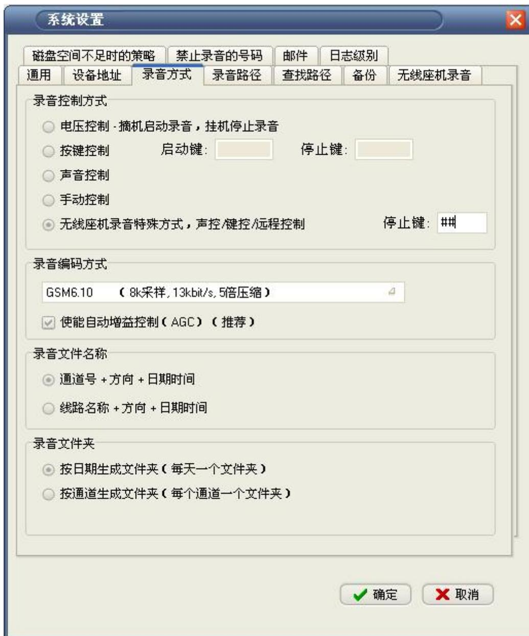
图 7.3 选择无线座机录音的录音启动方式
