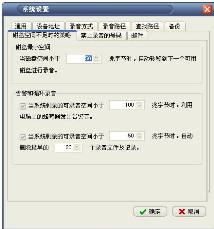
图 6.4 设置告警和循环录音参数
