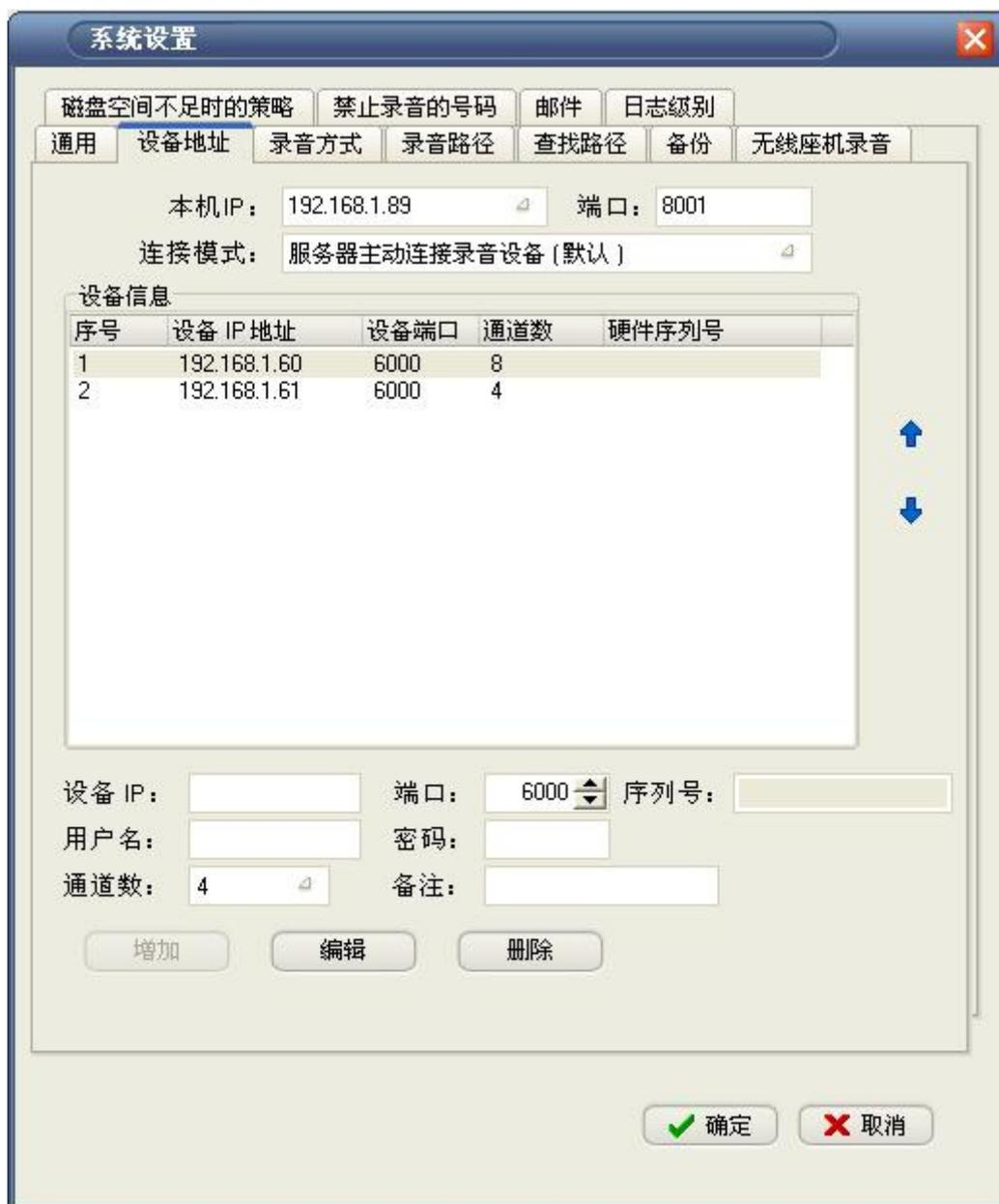
图 4.5 设置要连接的录音设备的访问参数
